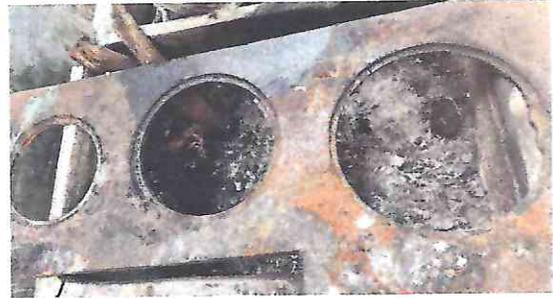
Foto 8: sustitución de plancha de metal de 3 hornillas
